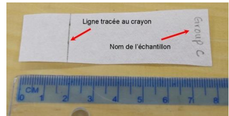
Figure 1 : Tracer la ligne d'origine et le nom de l'échantillon sur une bande de papier.
